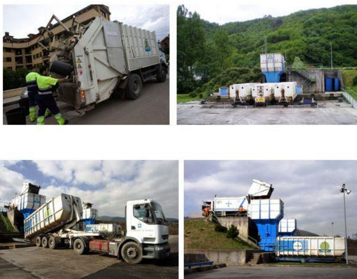
Imagen 6. 4 Ejemplo de planta de transferencia con compactación 52 .
